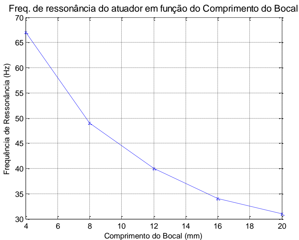
Figura 5.8: Análise de sensibilidade do atuador em função do Comprimento do Bocal - Frequência de Ressonância.
