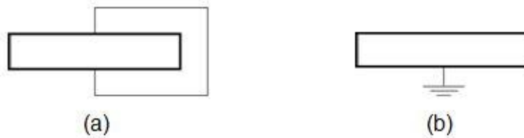
Figura 2.5 - Potencial elétrico em cerâmicas piezelétricas para obtenção de: (a) frequências de ressonância e (b) anti-ressonância.
